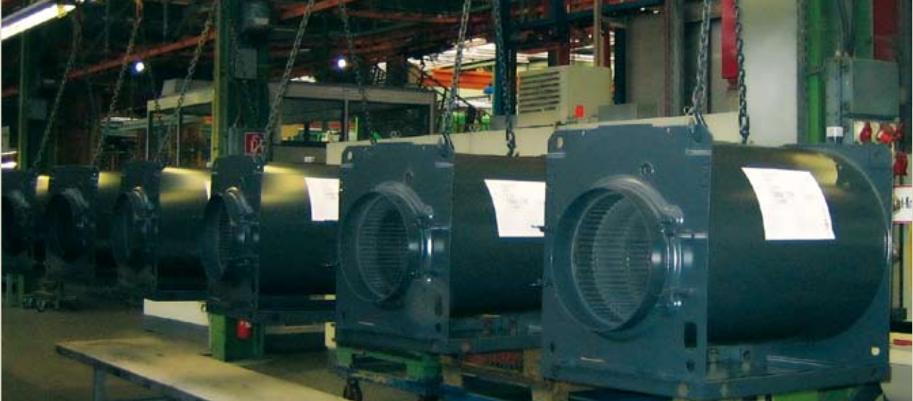
Materialversorgung für die Heizkesselfertigung
