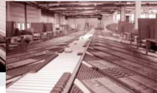
Vollautomatische Sortieranlage verteilt die Ware
